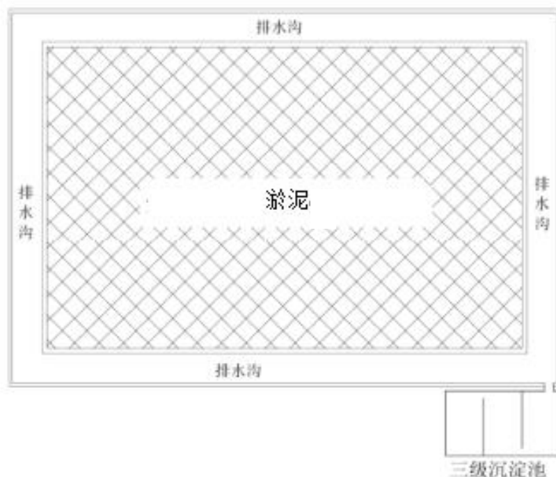
图 5-1 淤泥干化区平面布置示意图
