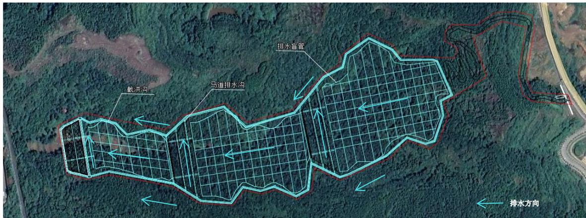
图 2-6 项目截洪沟、马道排水沟及排水盲管场场区布局示意图
